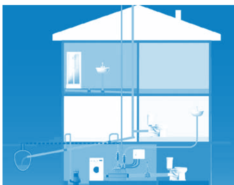
Рис. 1. Образец установки станции с погружным насосом:
